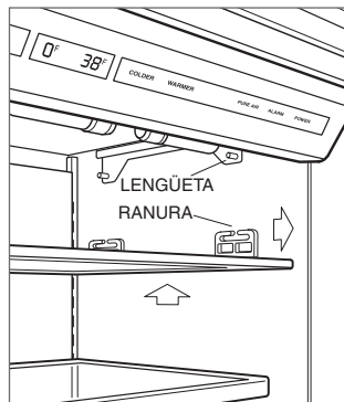
Instalación del difusor de luz
