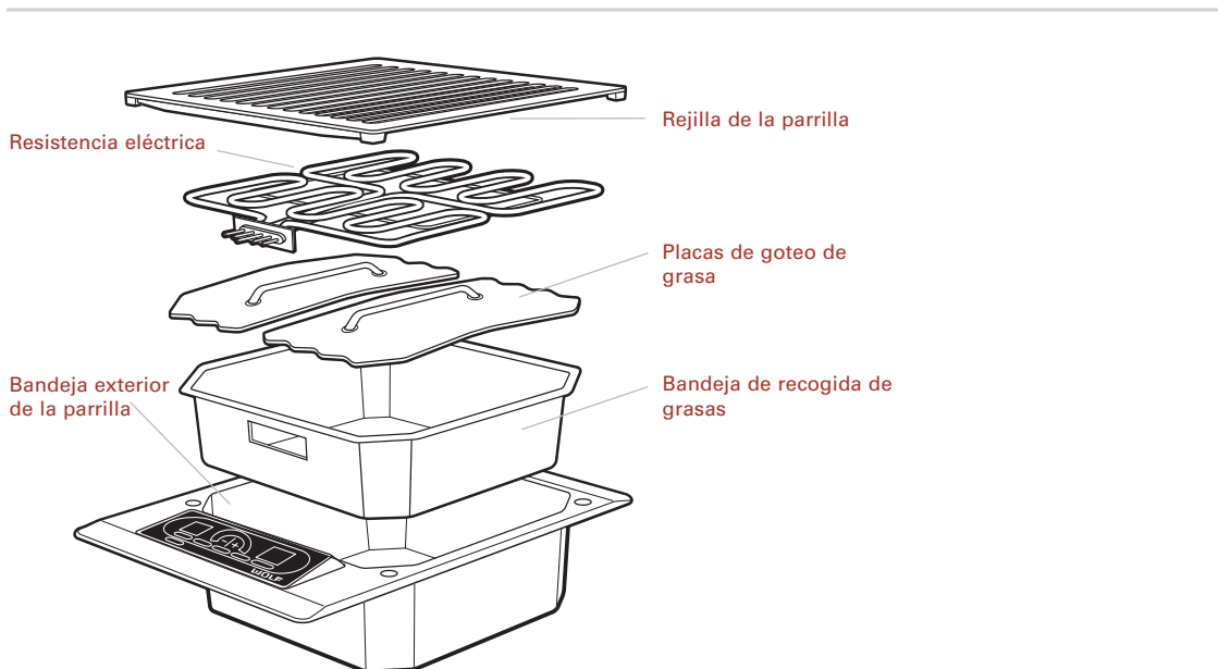
Montaje del módulo de parrilla
