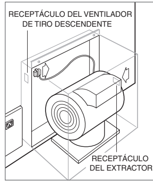
Conexión del extractor
