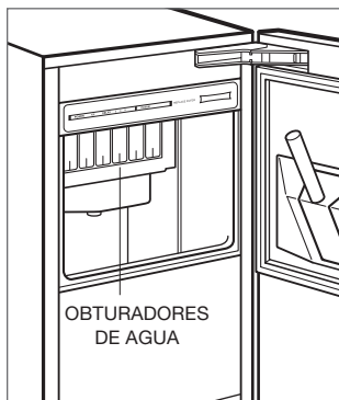
Ubicación de los obturadores de agua
