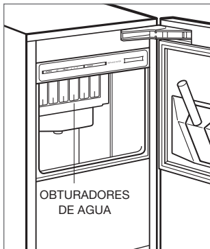
Ubicación de los obturadores de agua
